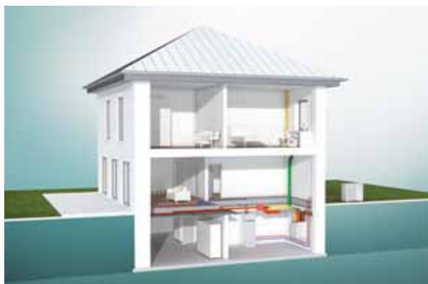
Funkčné schéma zapojenia: Centrálna rekuperačná jednotka recoVAIR a tepelné čerpadlo aroTHERM vzduch/voda s modulom uniTOWER značky Vaillant.
