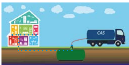
Žumpa na odpadovú „splaškovú“ vodu
