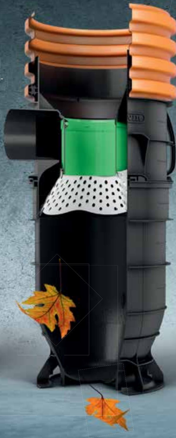
Uličná vpusť Tegra DN 425 s filtrom Súčasťou je sifón a 360° filter Objem kalového priestoru: 70 litrov Priemer odtoku: DN 200
