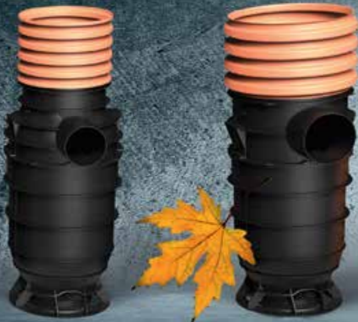
Uličná vpusť Tegra DN 315 s filtrom Súčasťou je sifón a 360° filter Objem kalového priestoru: 70 litrov Priemer odtoku: DN 160
