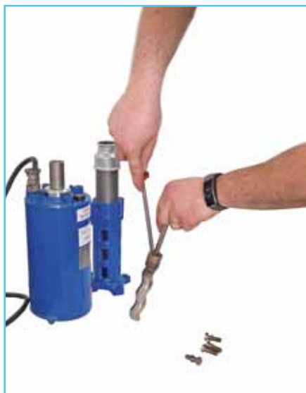
4/ Pozrieme, ktorá časť ponorky je poškodená, konkrétne diely vymeníme. Najčastejšie sú poškodené stator vretena, vreteno alebo hriadeľ, ktorý spája hydraulickú časť s motorom.
