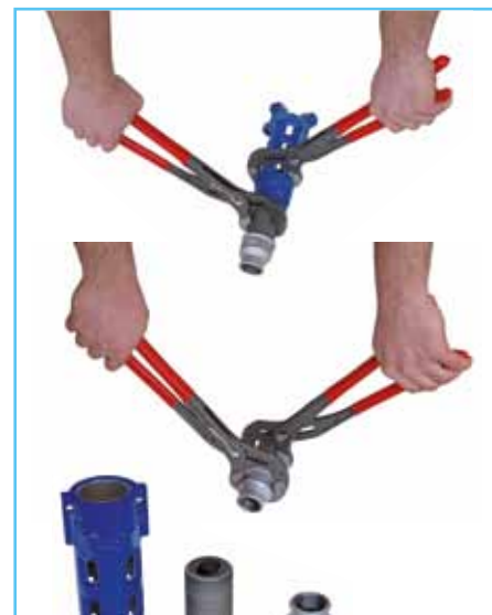
2/ Demontujeme hydraulickú časť ponorky z motora.
