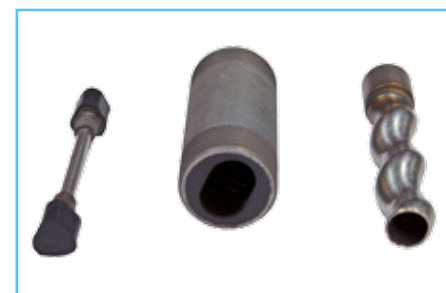
5/ Vytočíme stator ponorky z liatinového telesa.
